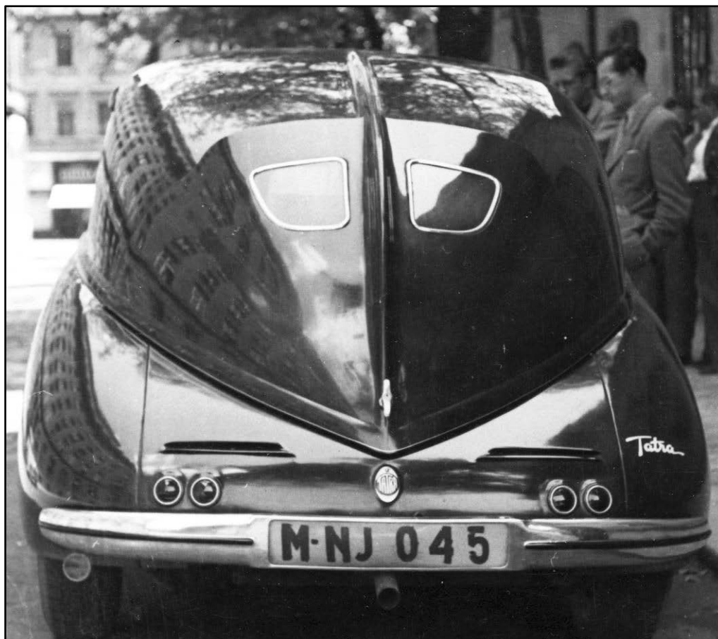
Pohled na zadní část vozidla Tatra T 600 Tatrapian. Zašpičatělý konec je typický pro většinu vozidel T 600 vyrobených v mateřském závodě v Kopřivnici. Kulatou zadní kapotu měla poslední série vyrobená v Kopřivnici a celá produkce 2100 vozidel T 600 vyrobená Automobilových závodech, národní podnik, Mladá Boleslav (Foto: Regionální muzeum Kopřivnice, o.p.s., Technické muzeum TATRA)
